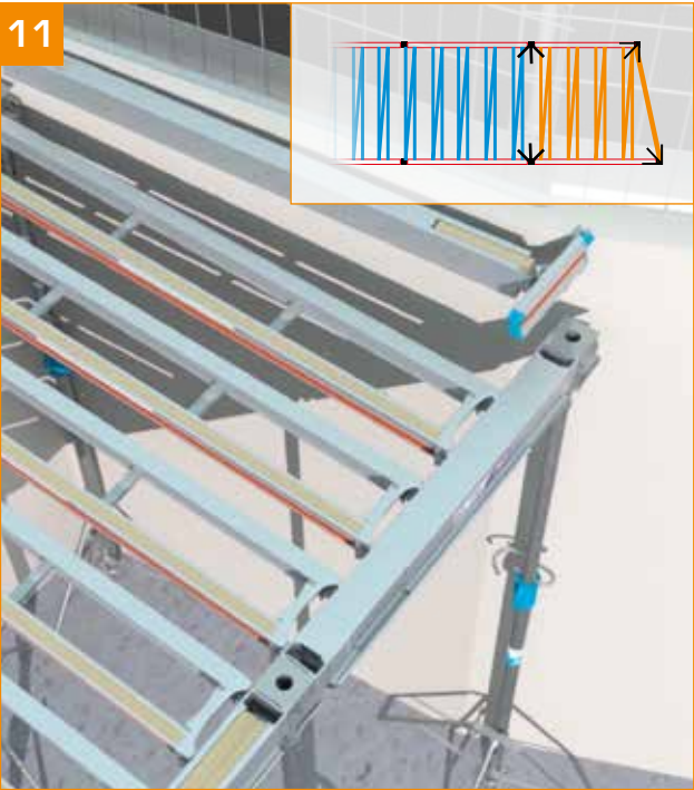
- Mettre en place la poutrelle secondaire angulaire.
