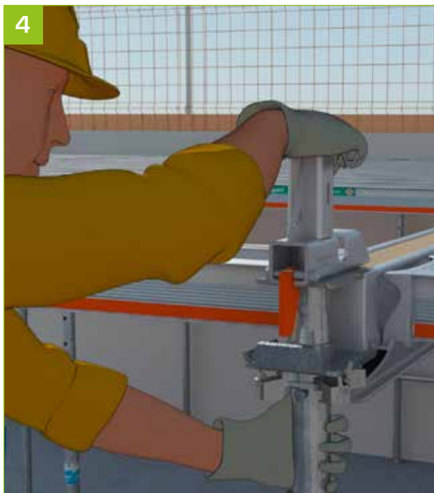
- L'anti-déboitement de l'adaptateur se verrouille automatiquement sur l'étais.
