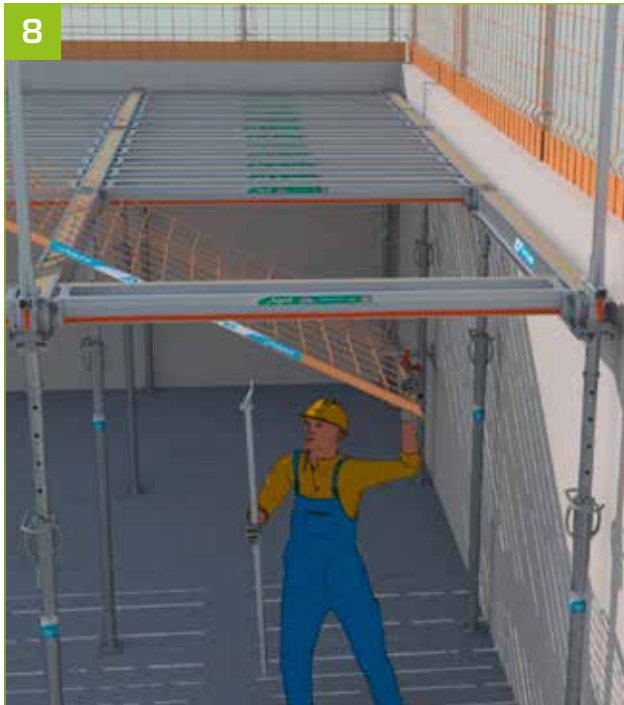
8 - Mettre en place la grille AlphiSafe de moins de 15 kg en la glissant sur le coffrage, la plinthe du côté des potelets et l'autocollant vers le haut.
