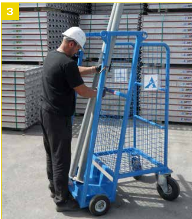
- Positionnement des étais dans le chariot.
