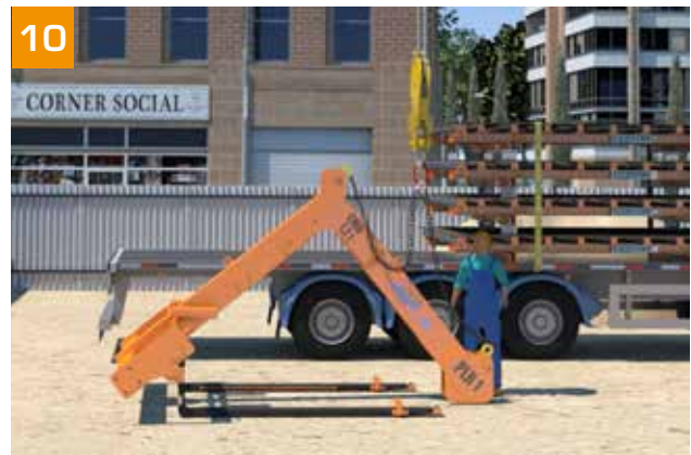
- Poser le palonnier au sol (il se replie).
